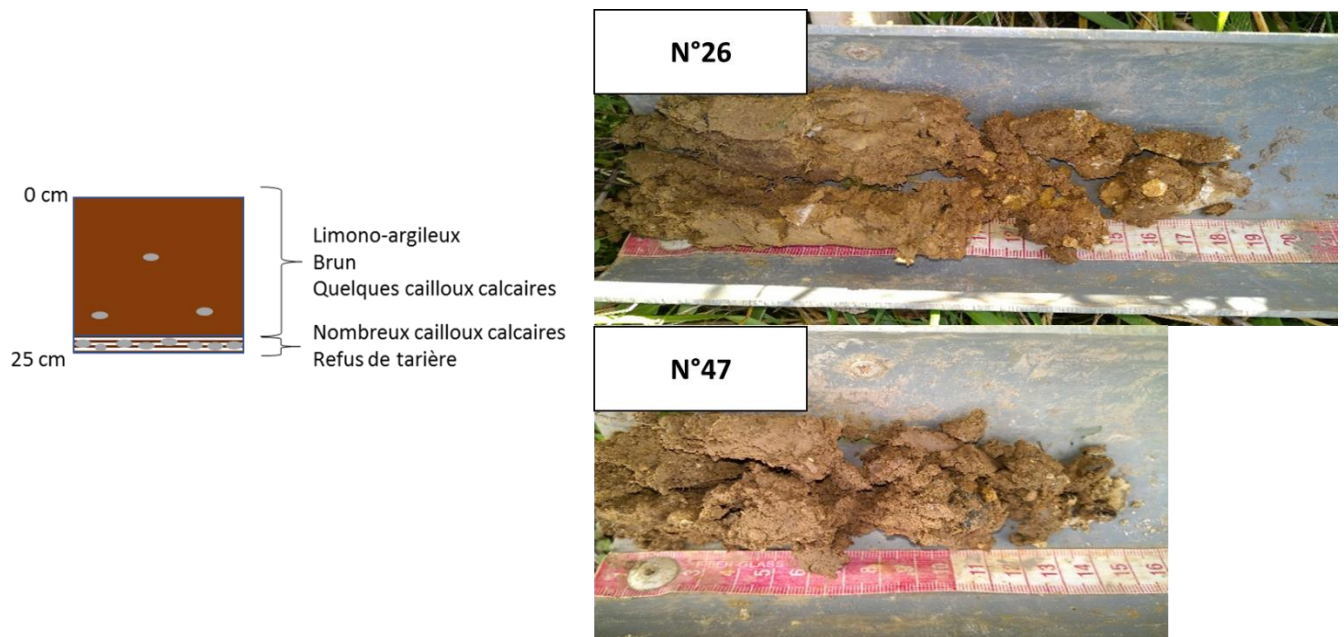
Figure 12: Illustrations du profil de sol n°1 (Source : NCA environnement)
